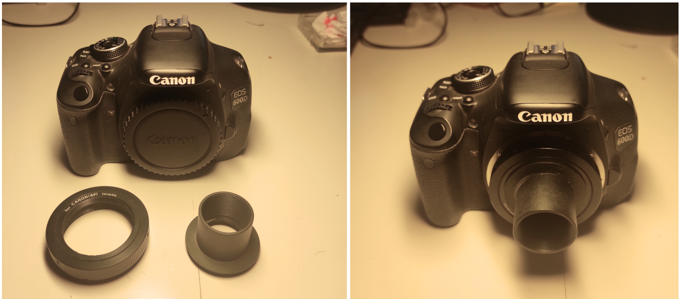
Câmara sem objectiva, anel T (à esquerda) e adaptador. À direita, o conjunto montado na câmara e pronto a utilizar.
